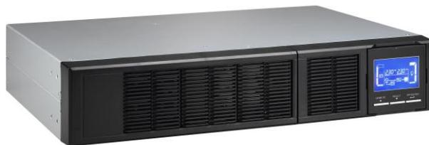
Mercury 系列 M120 产品是一款分布式电源系统，可直接安装部署于标准 19 英寸机柜中，采用 220VAC 输入，为负载提供高质量的 220VAC 电力输出及不间断供电保障。M120 产品容量为 3000VA/2400W，内置可热插拔锂电池包，整体高度 2U，由于锂电池具有能量密度高的性能优势，使得该产品可以实现满载放电时间达到 20 分钟以上。
